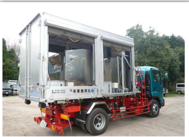
生ごみ液化プラントコンテナを備えた車両 (新明和工業㈱と共同発明)
